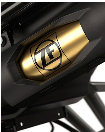
Suspensión regulable DYNAMIC ESA.
