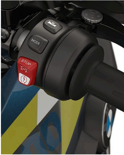
Puños calefactables con regulación de varias etapas.
