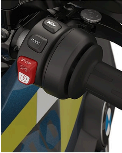
Puños calefactables con regulación de varias etapas.
